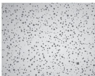
Рис. 2. Отливка №2. Графит шаровидный, ССГ 80% (x100)
