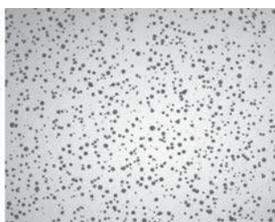
Рис. 3. Отливка №4. Графит шаровидный, ССГ 90% (x100)
